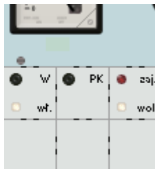
Rys. 3.2.1 Stan zasadniczy urządzeń, nastawianie przebiegowe załączone, grupa wybierająca wolna.
